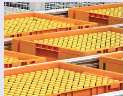
Termoformowana taca została zaprojektowana w konstrukcji ramowej, co pozwala na dopasowanie wkładek różnych rozmiarów
