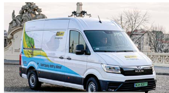
Zasięg MAN-ów e-TGE wynosi 140 do 150 km w zależności od warunków, zaś trwające 7-8 godz. ładowanie odbywa się nocą w magazynach
