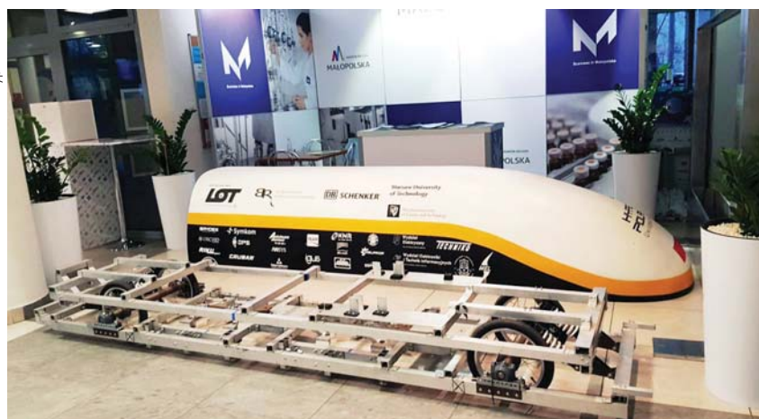
Magrail, technologia opracowywana przez Hyper Poland, opiera się na pasywnej lewitacji magnetycznej. Innowacyjne rozwiązanie Hyper Poland pozwala pojazdom na istniejących torach kolei poruszać się z prędkością 300 km/godz., a na torach kolei dużych prędkości – 415 km/godz.
