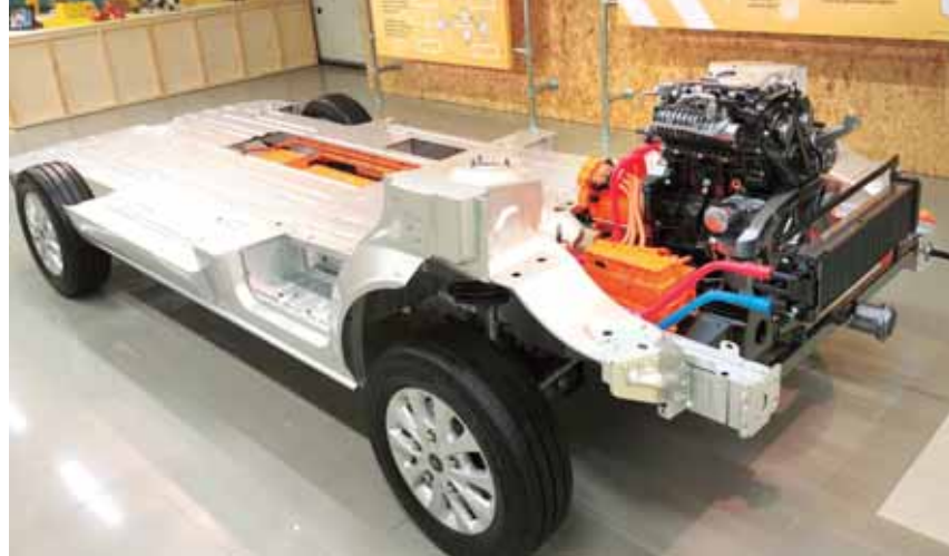
Hybrydowy napęd szeregowy to układ, w którym koła napędzane są bezpośrednio przez silnik elektryczny o mocy 93 kW. Nie ma tu skrzyni biegów, sprzęgła czy koła dwumasowego. Dzięki temu układ jest lekki, prosty w konstrukcji i mało awaryjny. Zapewnia też najmniejsze straty energii. 1-litrowy silnik spalinowy pracuje tu tylko jako źródło napędu dodatkowego generatora prądu. Zespół baterii o pojemności 13,6 kWh umieszczono pod podłogą ładowni, przez co nie ograniczają one przestrzeni ładunkowej i pasażerskiej
