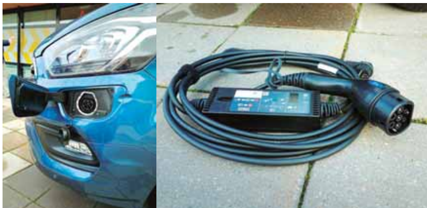
Akumulator Customa Plug-In ładowany jest na trzy sposoby. Podczas postoju można podłączyć go poprzez złącze Type-2 do ładowarki stacjonarnej albo ładowarkę przenośną do zwykłego gniazda 230 V. Podczas jazdy akumulator ładowany jest przez silnik spalinowy oraz poprzez odzysk energii przy hamowaniu
