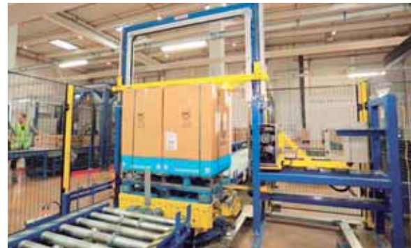
Moduł rozcinania opakowań zbiorczych to narzędzie, które tnie dostosowując się do grubości i jakości rozcinanego kartonu oraz wytrzymuje znaczne obciążenia mechaniczne. Dzięki niemu całkowicie wyeliminowano otwieranie opakowań przez pracowników
