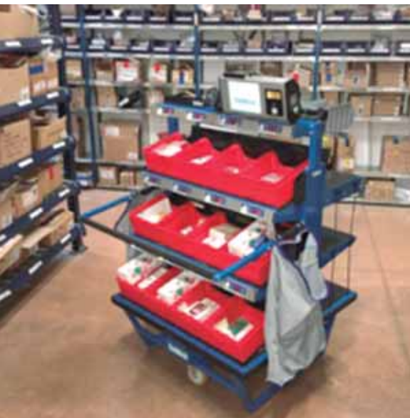
E-Shopper pozwala na znaczne skrócenie czasu kompletowania zamówień dokonanych przez Internet. Zadaniem tego inteligentnego koszyka jest optymalizowanie przygotowania zamówień internetowych
