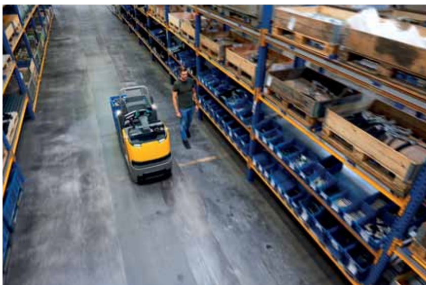
Wózek widłowy ECE z easyPILOT Follow sam podąża za operatorem, zatrzymując się w pozycji, w jakiej pracownik może wygodnie odłożyć i pobrać towar
