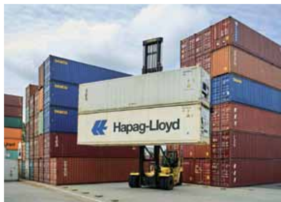
H8XM-EC6-H11XM-ECD9 do przeładunku pustych kontenerów charakteryzują się udźwigniem od 8 do 11 ton, zapewniając przy tym maksymalną wydajność pracy maszyny. Oznacza to, że operator może manipulować jednocześnie dwoma, ciężkimi kontenerami-chłodniami
