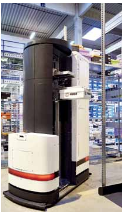
Robot kompletujący TORU wkłada kompletowane zamówienie w specjalne półki znajdujące się w jego obudowie. Po jego skompletowaniu robot podjeżdża do strefy pakowania, gdzie wykonywane są dalsze operacje
