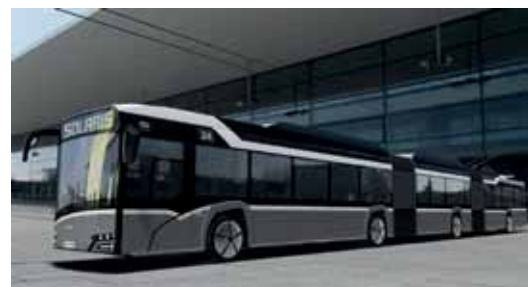
Jedną z premier 2018 r. ma być 24-metrowy, dwuprzegubowy trolejbus Solaris Trollino 24, który posłuży za bazę dla autobusów elektrycznych i hybrydowych
