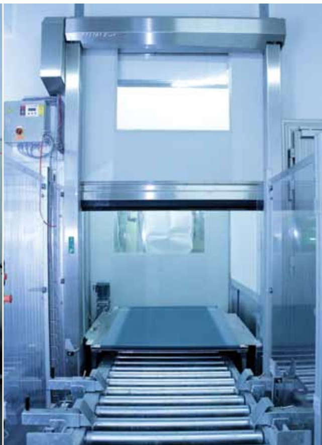
Montaż bram w zakładzie Hofmeister nie był łatwy, ponieważ obydwie bramy musiały być zintegrowane na taśmach przenośnikowych
