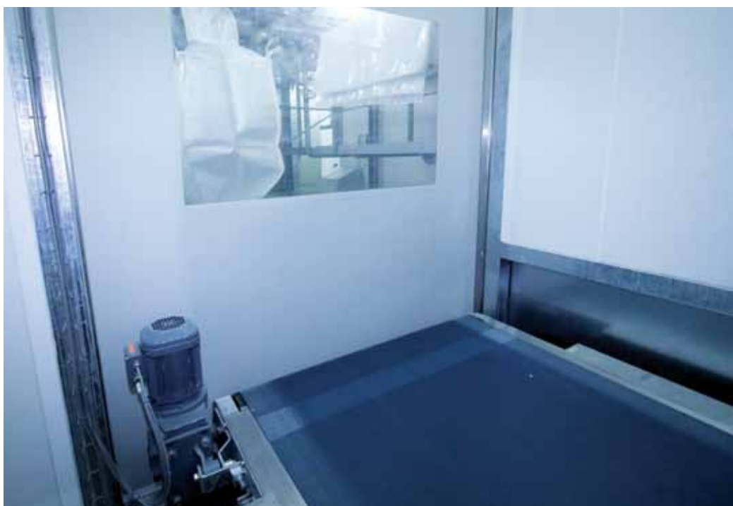
Konstrukcja bramy rolowanej jest wykonana ze stali szlachetnej, a pokrywy ościeżnic można łatwo odblokować i otworzyć w celu wyczyszczenia. BLVK zwraca szczególną uwagę na możliwość ich czyszczenia pianą oraz myjką parową
