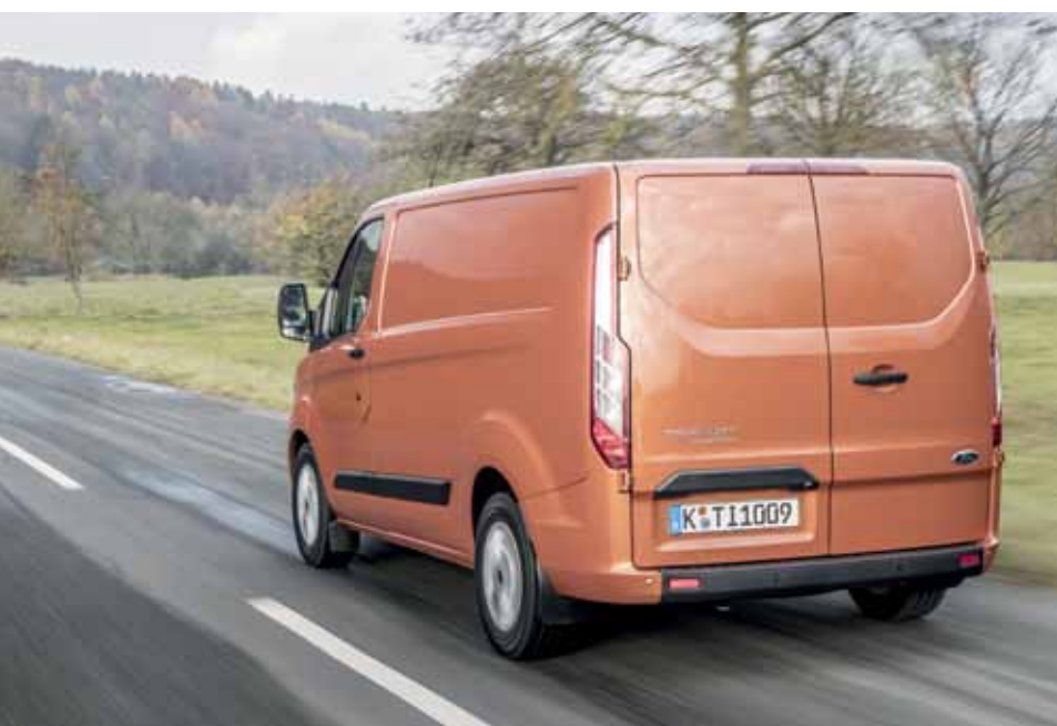
Dopuszczalna masa całkowita wynosi od 2,6 do 3,4 t, a ładowność do 1 450 kg. Szerokie drzwi boczne i niski próg tylny zapewniają łatwy dostęp do przestrzeni ładunkowej
