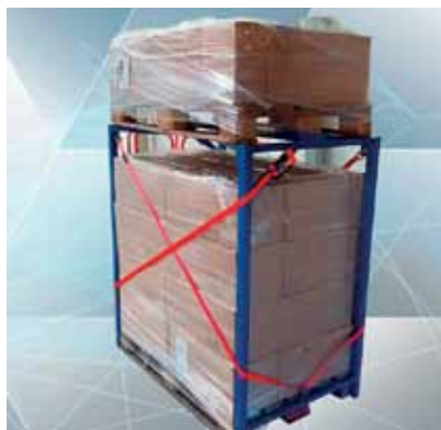
Na platformie w Wolborzu powstały pierwsze prototypy specjalnych ram, dzięki którym można na jedną nieregularną paletę towarów nadstawić drugą
