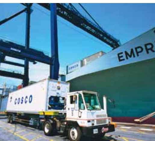
Monitorowanie temperatury panującej w chłodni podczas transportu (jej zakres to +2°C do +6°C) odbywa się dzięki termografom zainstalowanym w naczepach
