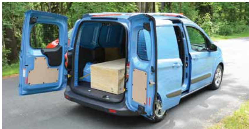
Transit Courier, przy całkowitej długości 4157 mm zapewnia objętość przestrzeni ładunkowej: 2,3 m 3 . Długość ładowni to 1,62 m, ale po złożeniu dzielonej przegrody (opcja) może wzrosnąć do 2,59 m po stronie pasażera. Maksymalna ładowność pojazdu to około 660 kg, co daje dopuszczalną masę całkowitą na poziomie 1795 kg
