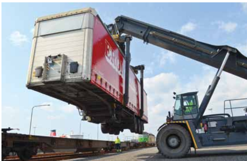
Szynami są przewożone ładunki w kontenerach, nadwoziach wymiennych, a nawet w specjalnych naczepach dostosowanych do takiego transportu.
