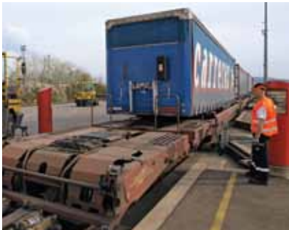
Transport naczeper z Bettembourg odbywa się w systemie Ro-La. Pojazdy wjeżdżają na wagony i są do nich mocowane za pomocą sworzni królewskiego. Możliwy jest przewóz różnych typów naczeper, nie tylko wzmocnionych, przystosowanych do załadunku pionowego.
