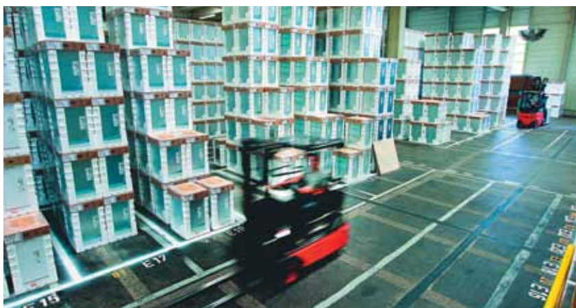
W magazynach tzw. dużego AGD dominującą formą układania produktów jest składowanie blokowe. Produkty układane są bezpośrednio na posadzce magazynu, warstwami w wyznaczonych polach i przenoszone za pomocą dedykowanych wózków
