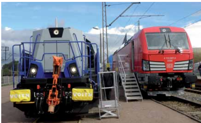
Po polskich torach jeżdżą lokomotywy Vectron wykorzystywane m.in. przez Deutsche Bahn. Jest to lokomotywa elektryczna produkcji niemieckiej, zaprojektowana przez Siemens Mobility jako następcą serii towarowych lokomotyw E189 EuroSprinter.
