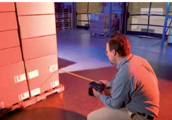
W magazynie zainstalowano anteny, które sczytują dane z tagów. Dane przekazywane są do systemu. Tak powstaje precyzyjna baza, w której znajduje się spis, jakie materiały używane są do produkcji mebli.
