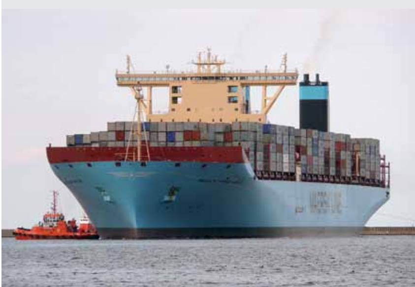
Maersk Mc-Kinney Møller otrzymał imię na cześć zmarłego w ub.r. Arnolda Maersk Mc-Kinney Møllera, syna założyciela koncernu AP Møller Maersk. Jednostka liczy 400 m długości, 59 m szerokości i 14,5 m zanurzenia.
