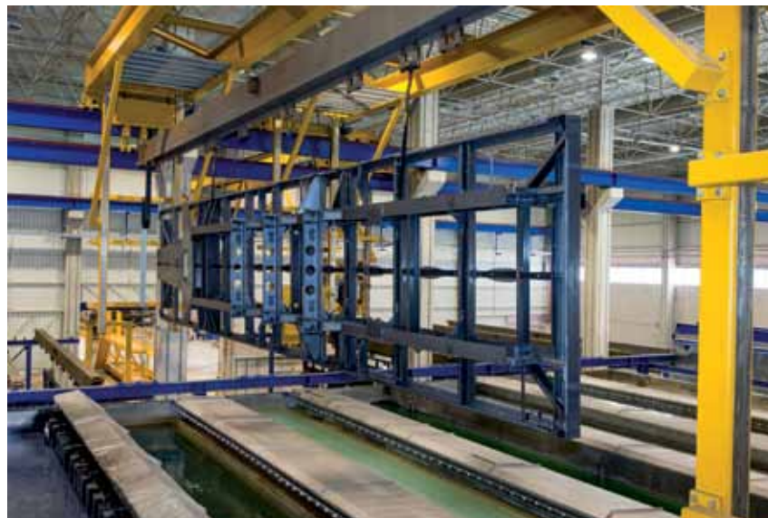
Produkowane w Tire pojazdy są zabezpieczane tak starannie jak w Werlte. Zbudowano w tym celu nowoczesną linię kataforezy.
