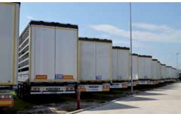
Profi Liner CS z burtami i zapięciem celnym jest jednym z trzech obecnych produktów zakładu
