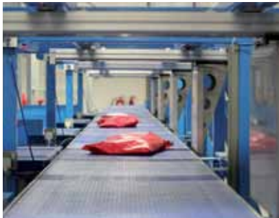
W trakcie pakowania indywidualnego zamówienia na opakowaniu umieszczona zostaje etykieta transportowa. Gotowa paczka trafia na jeden z dwóch transporterów, zależnie od tego w jakiej strefie była pakowana.
