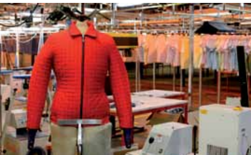
Prasowanie za pomocą wewnętrznego nadmuchu powietrza, na tak zwanych multiformach, sprawdza się doskonale w przypadku okryć wierzchnich
