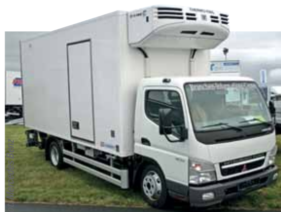
Utrzymywanie wymaganej temperatury podczas realizacji zadań transportowych ładunków szybko psujących się osiąga się stosując agregaty chłodnicze lub poprzez schładzanie skrzyni ładunkowej za pomocą azotu, który rozprężając się obniża temperaturę
