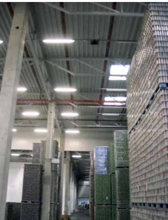
Towar na magazynie zmienia propagację fal radiowych, trzeba to brać pod uwagę podczas projektowania sieci
