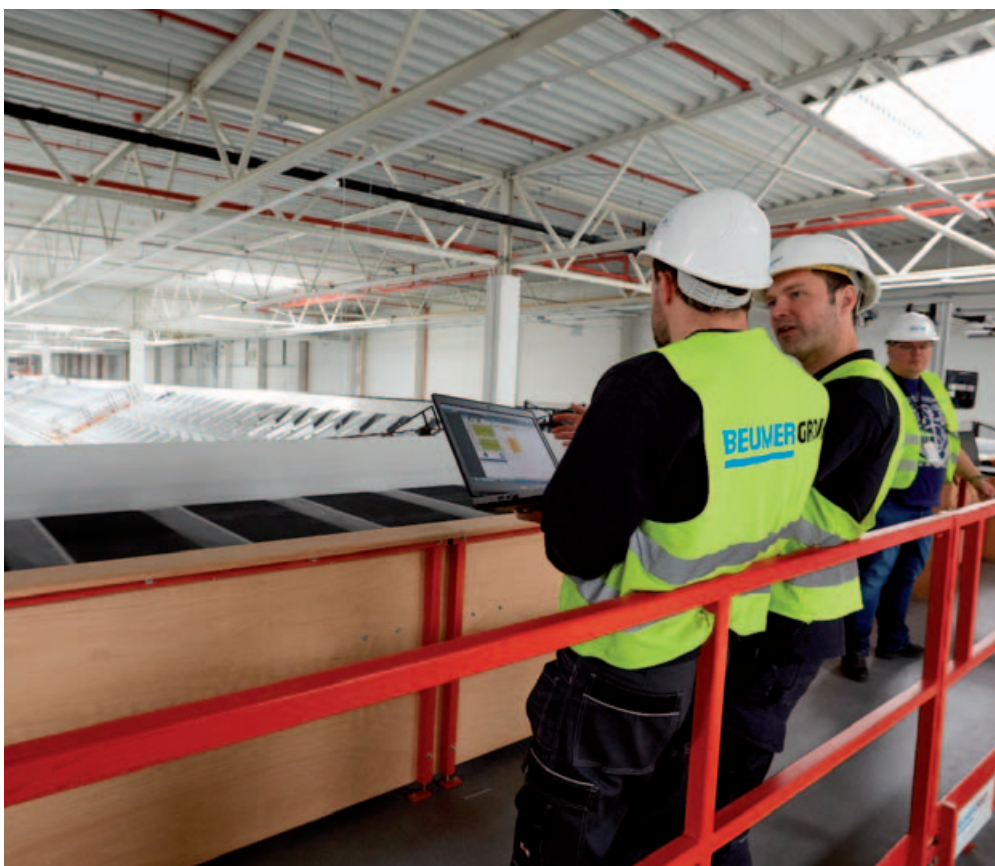
Pracownicy będą prowadzić zbiórkę towaru w regałach do pojemników, które następnie będą odkładane na taśmociąg i dostarczane do sortera. Po zeskanowaniu przed taśmą, będzie on odkładany manualnie na pustą tackę znajdującą się na sorterze, poruszającą się z prędkością 1,5 m
