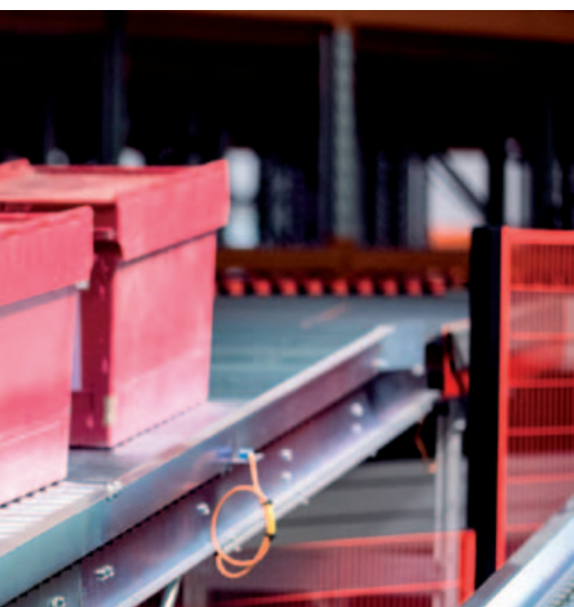
Shoe-sorter zapewnia wysoką wydajność oraz dokładność sortowania wielu rodzajów produktów. To poziomy system, którego przenośnik wykonany jest z tłoczonych profili aluminiowych
