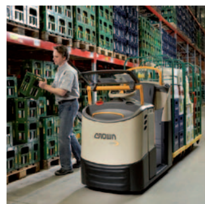
W zamkniętych halach magazynowych, w których składowana jest żywność, zastosowanie znajdują jedynie wózki z napędem elektrycznym wyposażone w baterie trakcyjne, w których nie zachodzi proces gazowania
