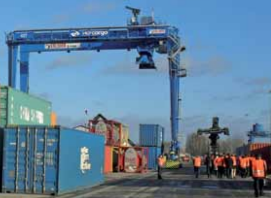
Terminal wyposażony jest we front przeładunkowo-składowy z placem B, a także w halę celno-garażową, trzy suwnice szynowe, suwnicę kołową typu Kalmar i reachstackery
