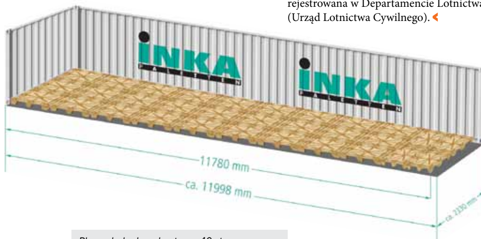
Plan załadunku – kontener 40 stopowy załadowany 31 paletami F76 760×1140 mm
