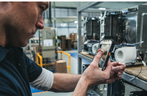
Toughpady Panasonic łączą w sobie funkcje tabletu, smartfonu i przenośnego terminalu. Urządzenia są odporne na upadki z wysokości 1,8 m, posiadają oznaczenie stopnia ochrony IP67, co oznacza, że są pyłoszczelne i chronione przed skutkami krótkotrwałego zanurzenia w wodzie
