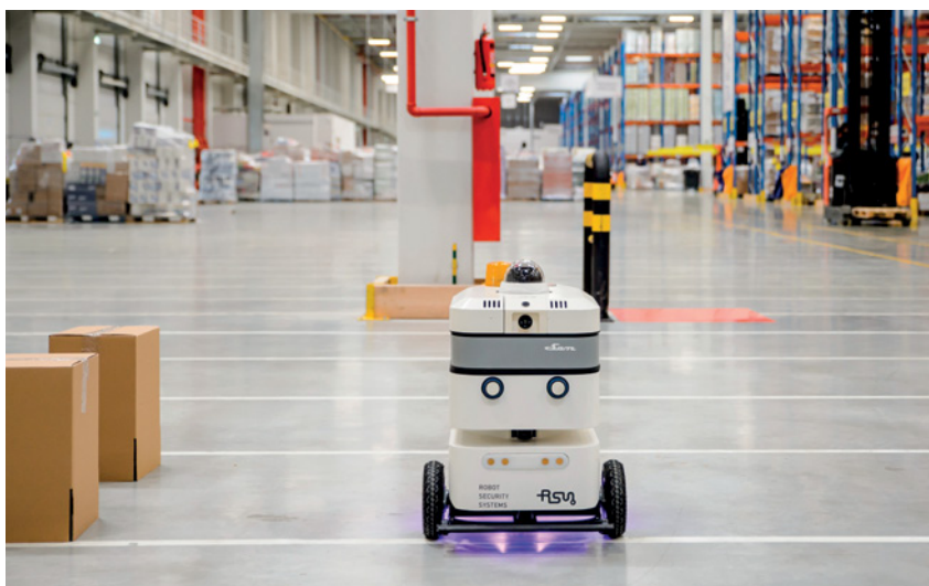
SAM Robot, poruszający się z prędkością 2,5 m/s, ma m.in. wbudowaną kamerę 360°, mikrofon, czytnik kart identyfikacyjnych pracowników magazynu (wykrywa obecność człowieka i identyfikuje jego tożsamość), oraz czujniki gazu, dymu, ciepła, toksyn i dźwięku
