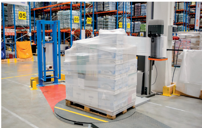
W Strefie Kontroli Szczegółowej umieszczono foliowarki z zainstalowanymi dwiema kamerami o wysokiej rozdzielczości (każda z nich ma 10 MPX i zoom), które wykonują zdjęcia każdej strony palety. To pozwala na dokładną rejestrację proces
