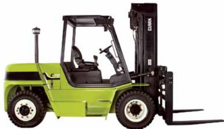
Wózki spalinowe LPG/DIESEL C40-C55 firmy Clark charakteryzują się udźwigiem od 5 do 8 ton. Wydajny silnik wysokoprężny o mocy 100 koni mechanicznych przekazuje moc na koła za pośrednictwem trzystopniowej skrzyni automatycznej
