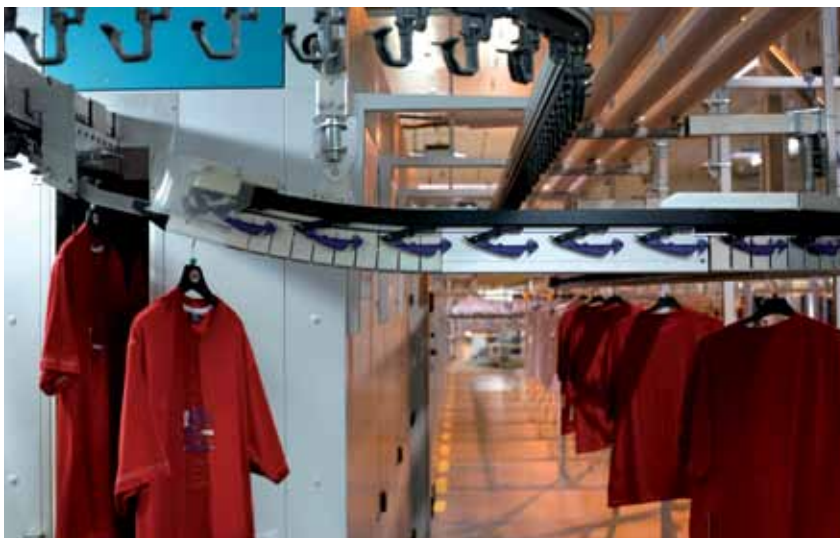
Do prasowania i odświeżania tkanin służy profesjonalny tunel prasowniczy, w którym za pomocą pary odzież jest przygotowywana bezpośrednio do sprzedaży w salonach firmowych
