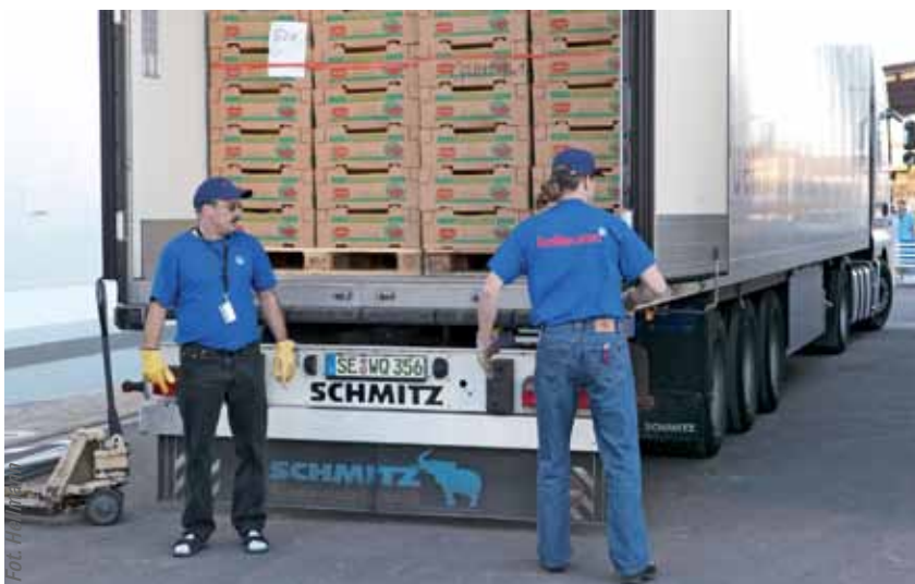
Najbardziej popularną paletą i najszerzej stosowaną jest paleta EURO. Ma ona wymiary 1200 mm × 800 mm × 144 mm i ładowność do 1000 kg
