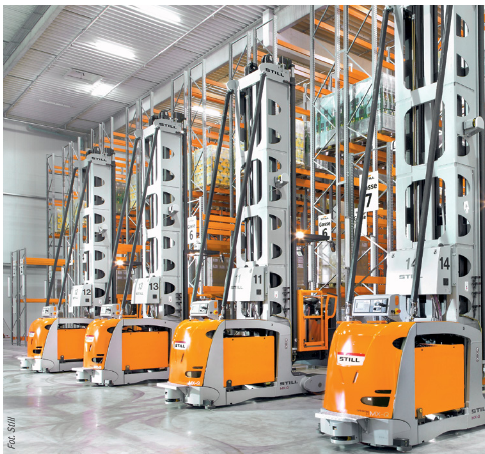
Model MX-X z widłami obrotowo – przesuwymi marki Still, o maksymalnym udźwigu 1500 kg. Maksymalna wysokość podnoszenia wynosi 12,85 m. MX-X można eksploatować w systemie prowadzenia szynowego, ale dostępny jest również z indukcyjnym systemem prowadzenia wymuszonego. Technologia ta umożliwia szybkie, bezpieczne i bezbłędne wprowadzenie wózka na tor jazdy, niezależnie od tego jak wąskie i pod jakim kątem ustawione są korytarze
