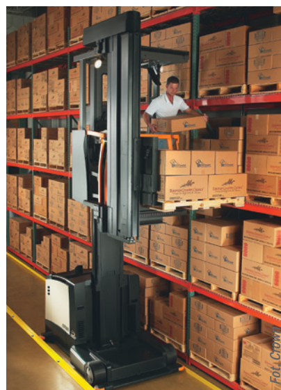
Seria TSP 6000 Crown zapewnia wszechstronną obsługę w zakresie magazynowania, od pełnego odstawiania i podnoszenia palet do transportu i organizacji. Pracując w przejściach tylko nieznacznie szerszych niż sam wózek, seria TSP 6000 może podnosić palety na wysokość 12.6 m, przy maksymalnej pojemności 1250 kg
