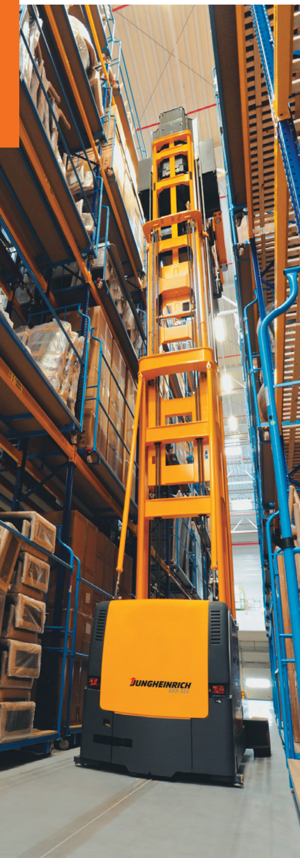
Jungheinrich EFX 515 można wyposażyć w moduł unoszenia, który pozwala uzyskać prędkość unoszenia na poziomie 0,52 m/s i zapewnia optymalizację ruchu obrotnicy wideł poprzez rozpoznanie ładunku
