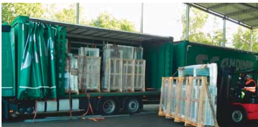
Produkty stolarki okiennej i drzwiowej powinny być zawsze przewożone na stojakach. Stojaki mogą być drewniane (jednorazowe) lub metalowe (wielokrotnego użytku)
