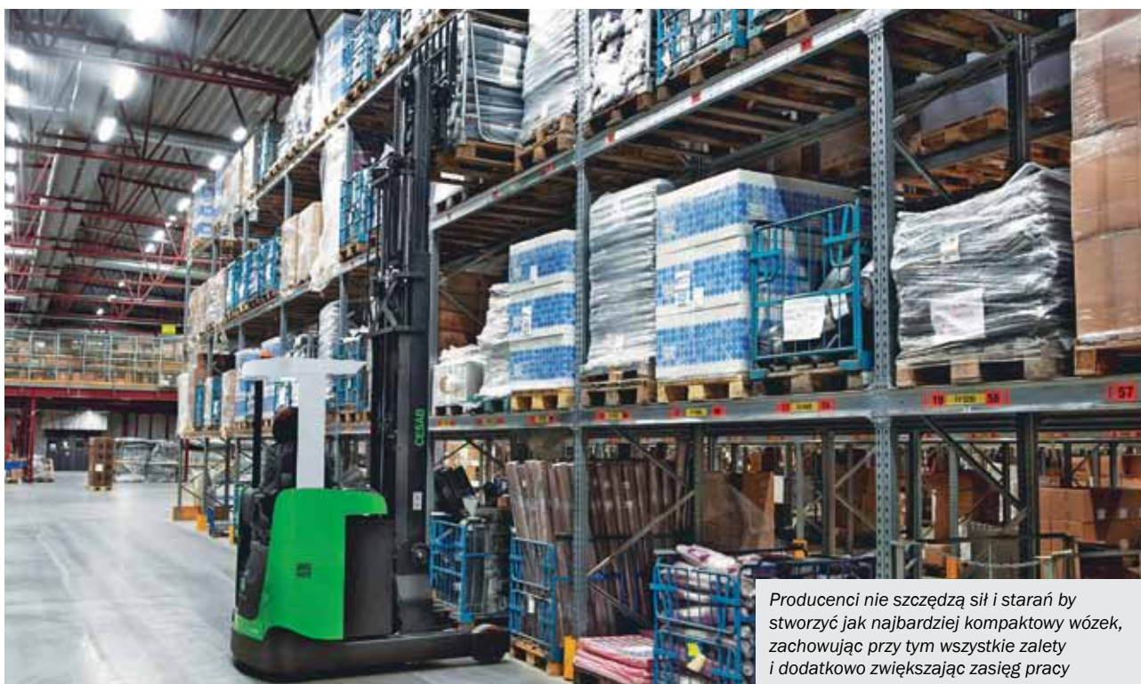
Mitsubishi oferuje również czterokierunkowy wózek RBM20-25K. Możliwość poruszania się we wszystkich kierunkach czyni go znacznie sprawniejszym. Dodatkowo może być wykorzystywany do transportu dłużej – jako wózek boczny
