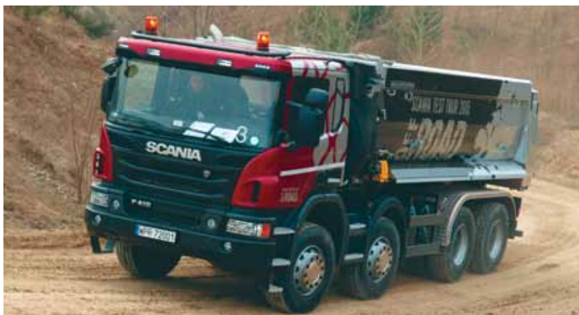
Scania P410 z niską kabiną, napędem 8x4 i zabudową Meiller. Tego typu pojazdy cieszą się dużym uznaniem wśród polskich klientów
