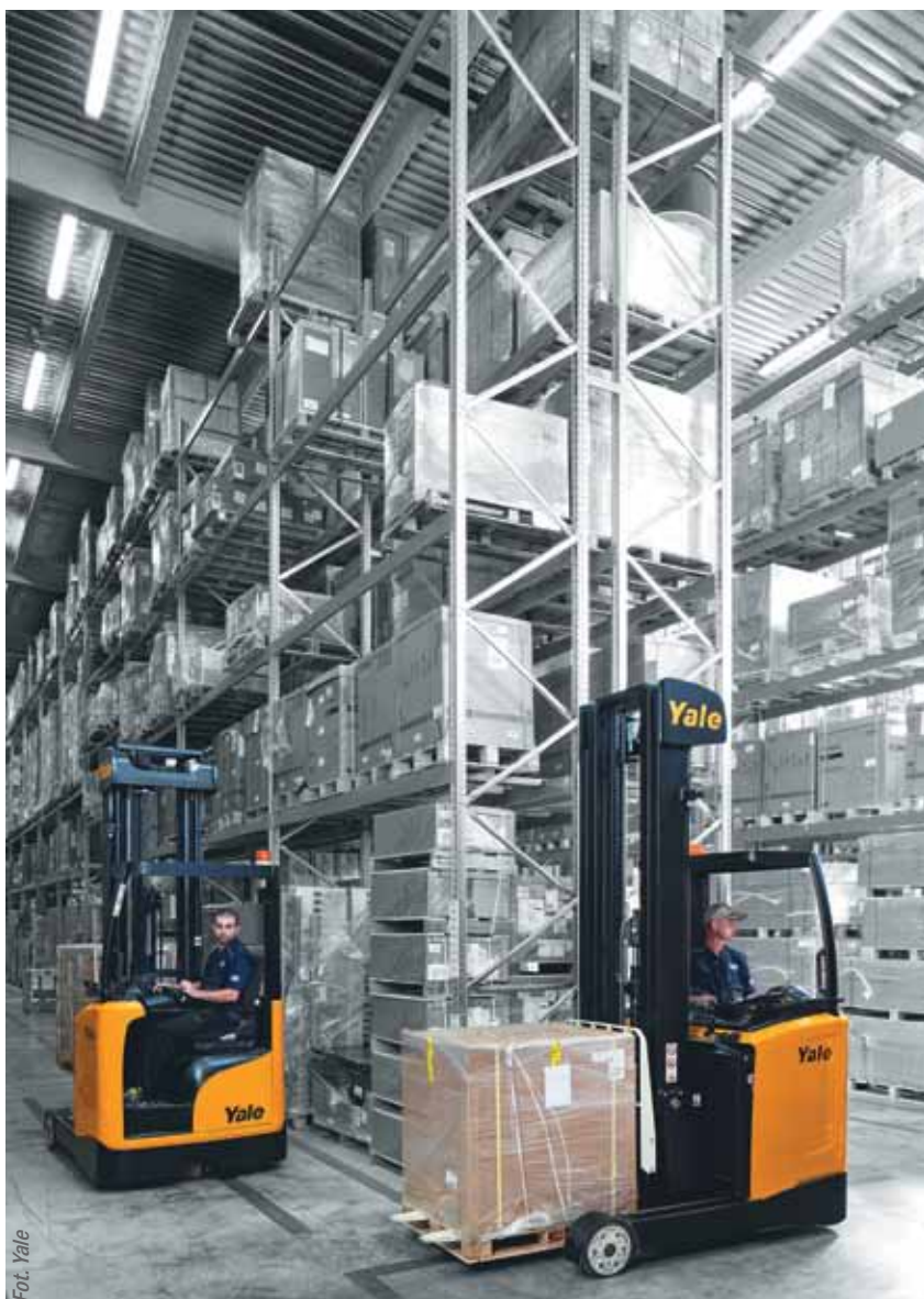
W magazynie można spotkać wózki do kompletacji poziomej. Gama i rozpiętość tego rodzaju sprzętu również jest bardzo bogata – od prostych prowadzonych dyszlem, aż do dwupoziomowych (o podwójnych widłach). Najprostszym rozwiązaniem jest popularny paletniak
