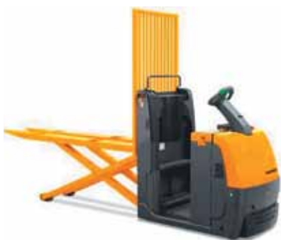
Wózek do kompletacji poziomej Jungheinrich ECE 320 z możliwością uniesienia widel – ułatwiającej pracę operatora
