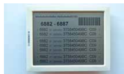
ePaper mocowany na wózkach zastępuje drukowane kartki z informacją o zawartości spakowanego wózka. Zastosowanie ePaper'u pozwala na ogromne oszczędności pieniędzy i środowiska naturalnego
