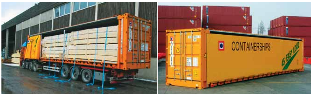
Jedną z poprzednich kontenerowych innowacji, były pojemniki 45'HC pallet-wide, mieszczące podobną liczbę palet jak standardowe naczepy samochodowe. Rynek (zwłaszcza żegluga bliskiego zasięgu) zaakceptował je dość szybko
