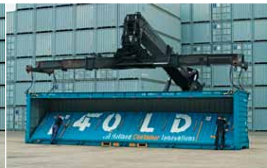
Największą zaletą kontenerów o nazwie 4Fold, firma Holland Containers Innovations BV (HCI) jest to, że gdy są puste mogą być składane, dzięki czemu zajmują jedynie 25% powierzchni standardowego pojemnika
