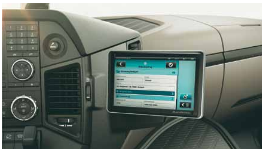
Pokładowe urządzenia pozwalają komunikować się z kierowcą, a jemu samemu służą pomocą w drodze. Ich elementem jest nawigacja oraz aplikacje pozwalające szybko odnaleźć najbliższy, autoryzowany serwis
