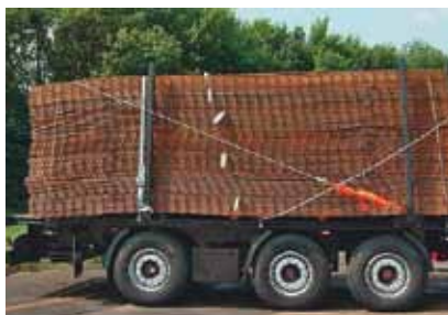
Liny stalowe posiadają podobne zastosowanie co łańcuchy. Podczas ich stosowania należy pamiętać o tym, że w przypadku zgięcia liny na krawędzi jej wytrzymałość zmniejsza się w zależności od średnicy zginania
