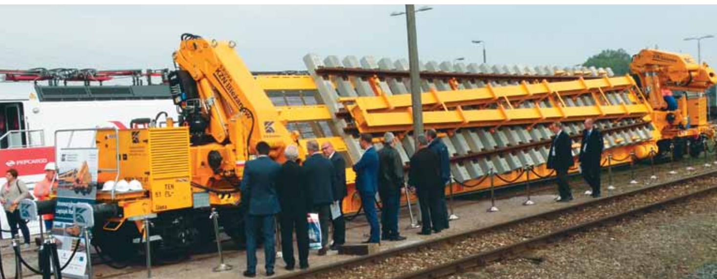
Switcher – pojazd szynowy KZN Biezanów umożliwiający przewóz wszystkich typów rozjazdów
