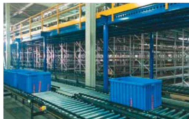
Wielopoziomowy system automatycznego transportu, kompletacji i identyfikacji towarów w przemyśle lekkim (realizacja PROMAG)
