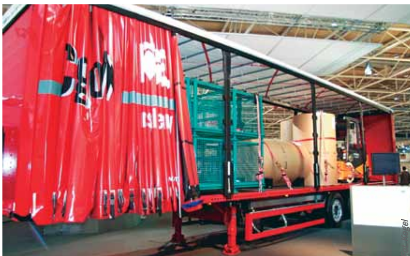
Odciąg to urządzenie unieruchamiające, którego zadaniem jest związanie elementów ładunku ze sobą i/lub z platformą ładunkową. Odciągi powinny być instalowane w taki sposób, aby stykały się wyłącznie z unieruchamianym ładunkiem i/lub punktami mocowania
