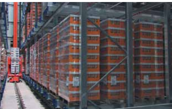
Regały z układnicami nie potrzebują ani światła, ani ciepła więc mogą pracować w nieoświetlonym i nieogrzewanym magazynie
